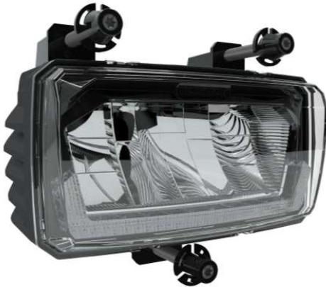
El Órizzon 5 es un faro automotriz moderno y compacto, con 5 funciones independientes (luz de posición delantera, luz direccional delantera, DRL, luz alta y luz baja), permitiendo una modularidad única y libertad de elección entre las funciones. Su diseño contemporáneo, discreto y elegante, junto con un excelente rendimiento, lo convierte en una solución innovadora para quienes buscan sofisticación y versatilidad en un producto liviano de solo 125mm de ancho.
